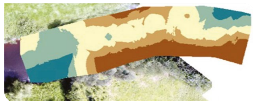
Fíoracha ó bhun go barr. Barr - samhail 3T den mhoirfeolaíocht lionsrutha. Meán - Dáileadh substráite in 2021 agus ar bun dáileadh substráite in 2022.
